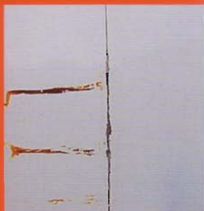
Testblech Dickschicht nach 500 h
