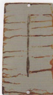
ESKAPHOR Z 1000 C Salzprüfetest nach DIN EN ISO 9227:2006 600 Stunden < 2 mm durchschnittliche Unterwanderung
