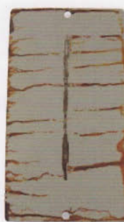
ESKAPHOR Z 1000 C Salzprüfetest nach DIN EN ISO 9227:2006 600 Stunden < 2 mm durchschnittliche Unterwanderung
