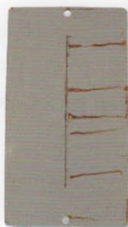
ESKAPHOR Z 1000 C Salzprüfetest nach DIN EN ISO 9227:2006 240 Stunden 0 mm Unterwanderung
